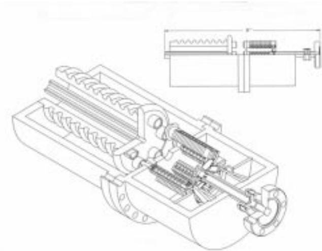
**Fig. 18** W-Band Modular Klystron
