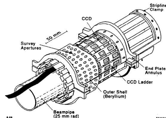
Fig. 3.4. The SLD Vertex Detector (VXD).
