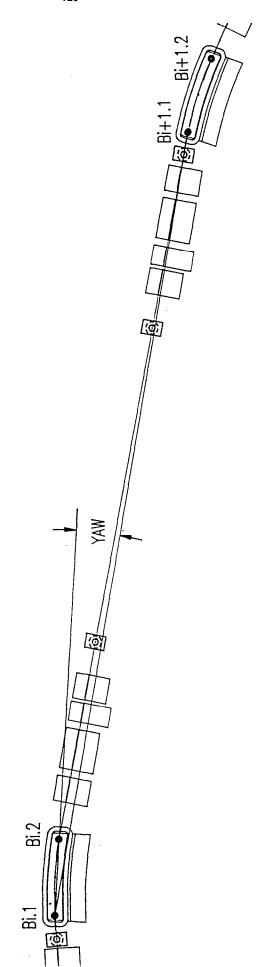
FIG.8 YAW ANGLE FOR THE BENDING MAGNET
