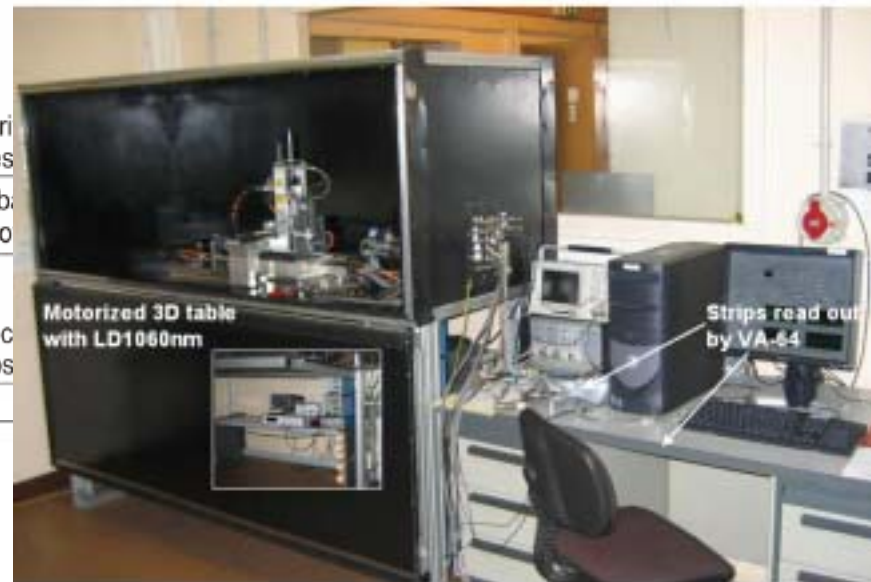
SIGNAL / POSITION LASER laser LD1060 avec collimateur F = 18 mm T = 50 ns
